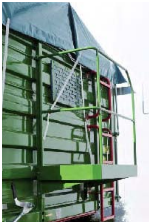
фото: смотровое окно в передней стене облегчает контроль уровня загрузки прицепа
