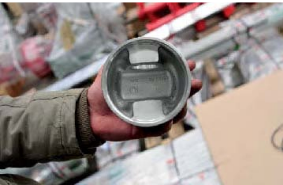
фото: оригинальные запасные части можно узнать по выбитым на них торговым знакам производителя
