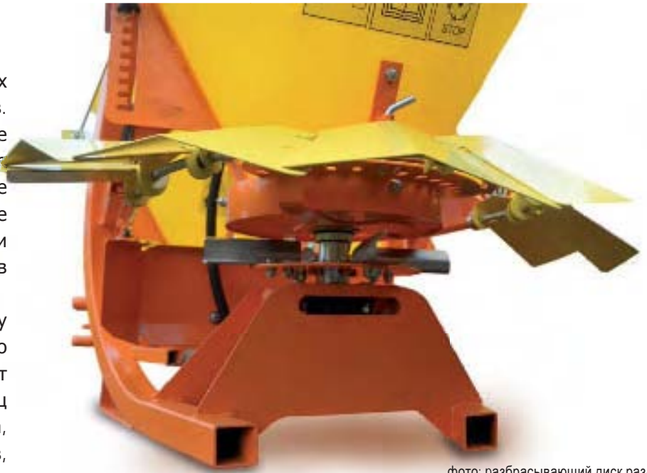
фото: разбрасывающий диск разбрасывателя песка PRONAR PS-250
