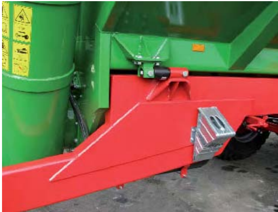
фото: весовая система (чёрный элемент)
