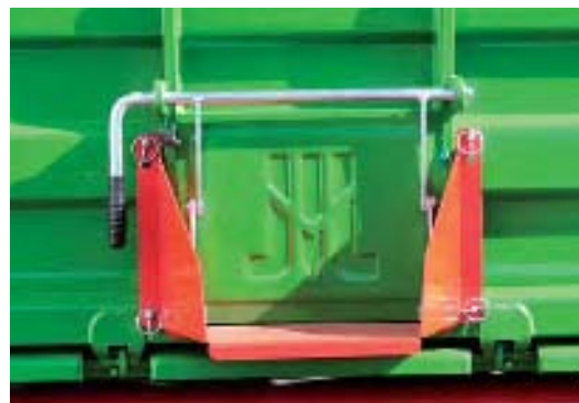
фото: ссыпное окно в задней стене позволяет упаковать сыпучие материалы или замонтировать шнек
