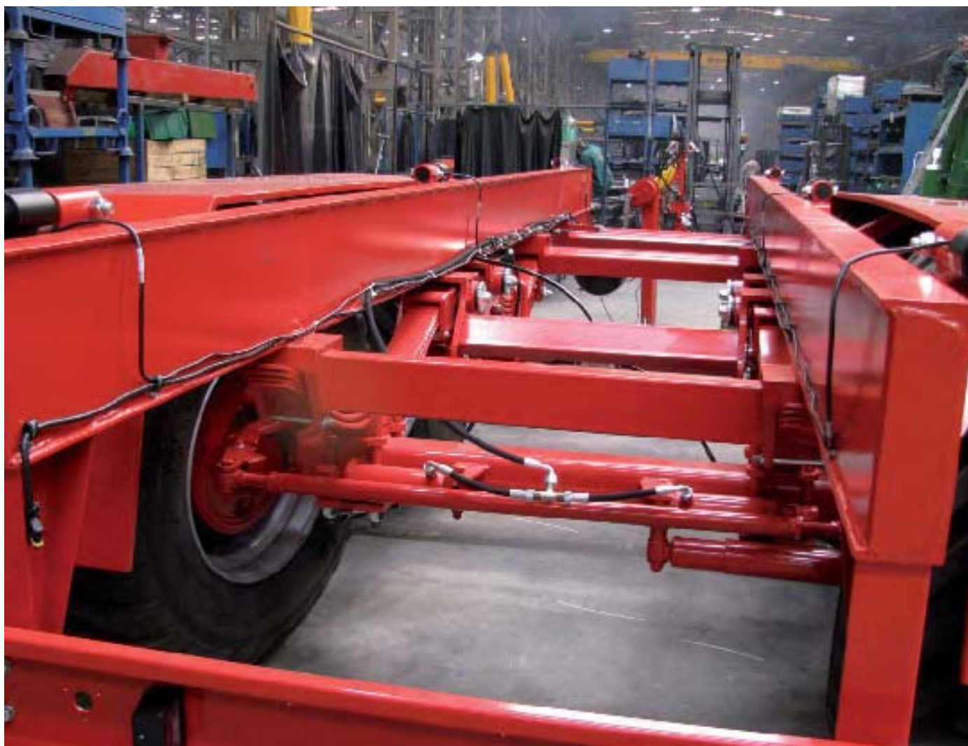
фото: поворотная передняя ось позволяет легко маневрировать
